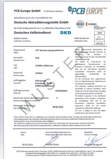
Kalibrierzertifikat eines Beschleunigungssensors nach ISO 17025.
