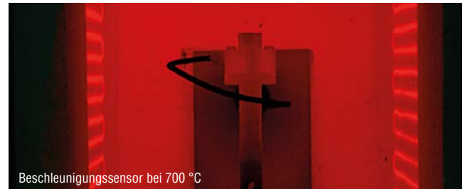
Modell EX611A00 kurzzeitig bis 704 °C, differentieller Ladungsausgang, ATEX
