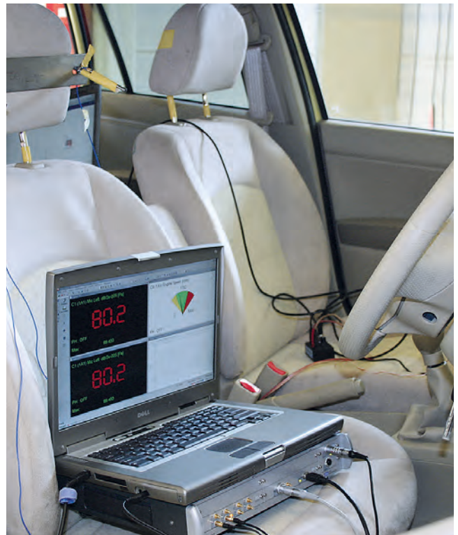
Messung der Geräusche im Innenraum
