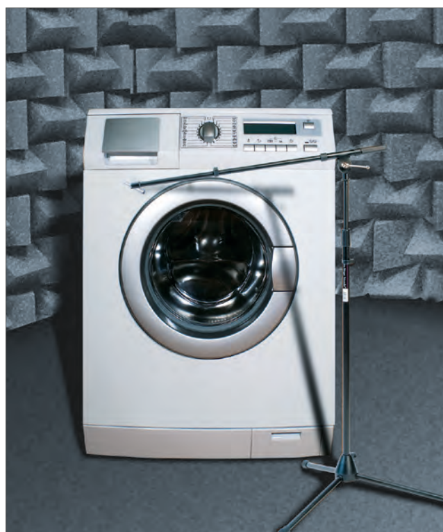
Ermittlung der Schallquellen bei Haushaltsgeräten zur Reduzierung der Betriebsgeräusche
