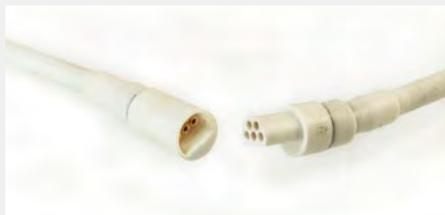
Messungen im Kraftfahrzeugsicherheitsbereich erfordern lange Kabel vom Messpunkt bis zur Datenerfassung. Kabel können beschädigt werden, was zu Verzögerungen und Zusatzkosten führen kann. Die M1-Anschlussoption ermöglicht das einfache Tauschen beschädigter Kabel, ohne den teureren Beschleunigungsmesser austauschen zu müssen.
