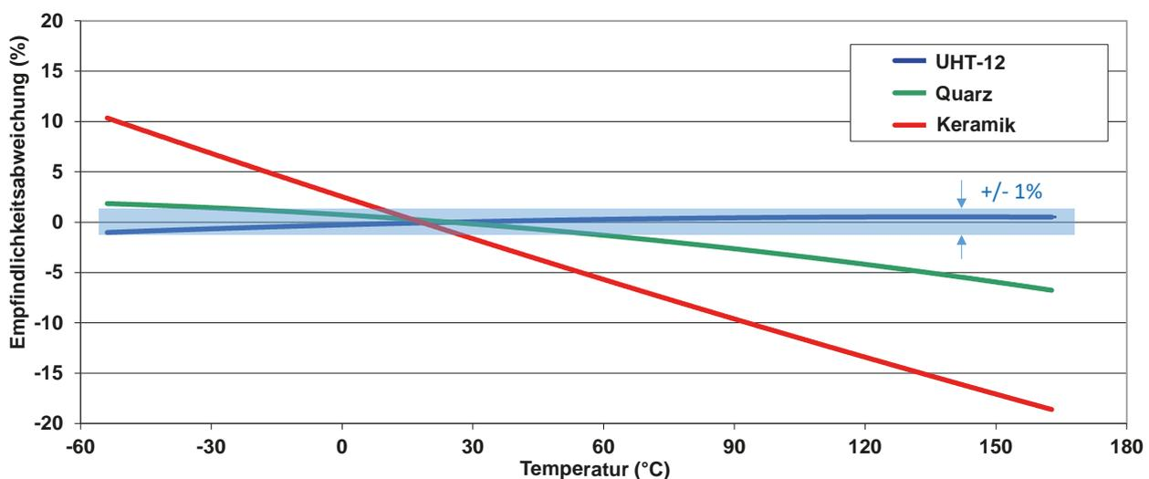
Der in den PCB-Produktspezifikationsblättern definierte Temperaturempfindlichkeitskoeffizient wird berechnet, indem die Steigung der Tangentenlinie an einem bestimmten Punkt im Diagramm „Empfindlichkeitsabweichung über Temperatur“ (siehe oben) bestimmt wird. Auf diese Weise ist der Temperatur-Empfindlichkeitskoeffizient bei jeder gegebenen Temperatur immer gleich oder niedriger als die Spezifikation.
