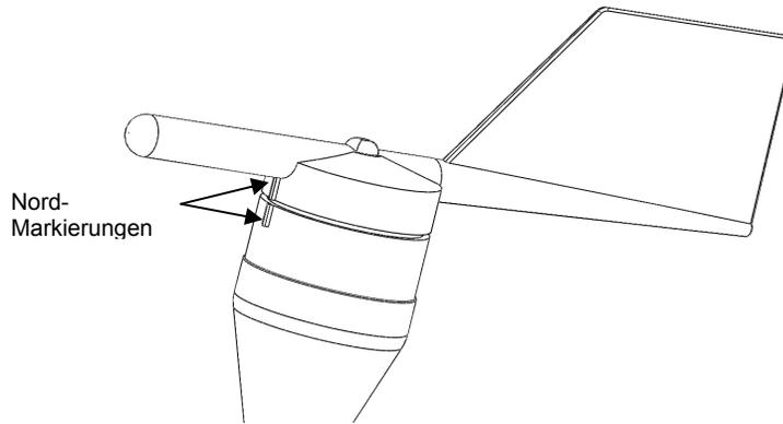
2. Befestigen Sie die Basis und den Schaft der Windfahne mit einem Stück Klebeband, sodass sich die Windfahne nicht drehen kann.
