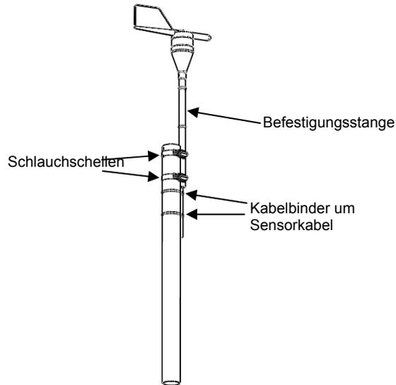
3. Ziehen Sie die Schlauchschellen fest und achten Sie darauf, dass die Befestigungsstange senkrecht bleibt.
