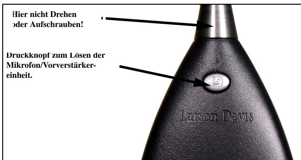
Abb. 2-4: Druckknopf zum Lösen der Mikrofon/Vorverstärkereinheit.
