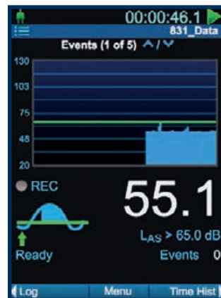
Eine laufende Aufnahme wird im Touch-Display des SoundAdvisor 831C angezeigt
