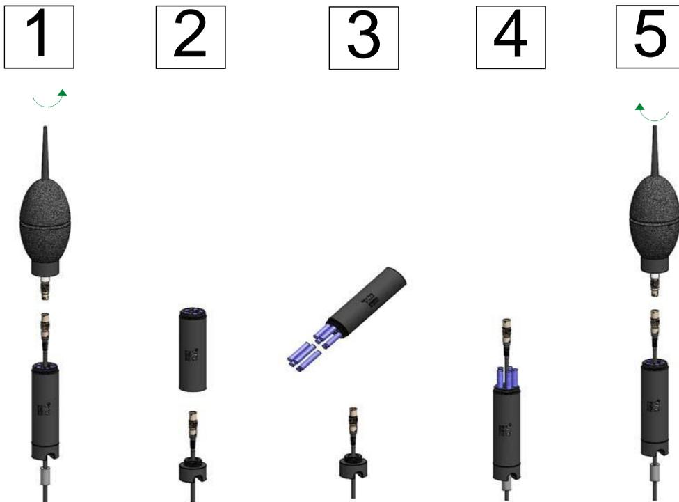
**Abbildung 3-3 Trocknungsmittel des EPS2116 ersetzen**
